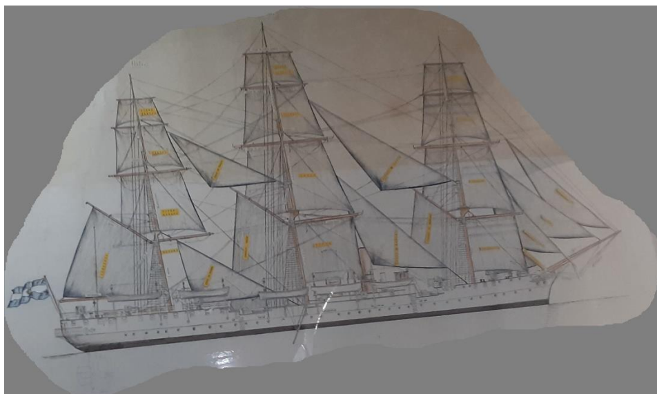
Figura 4 — Desenho do plano velico da Fragata ARAS Presidente Sarmiento em exposição no barco museu argentino
